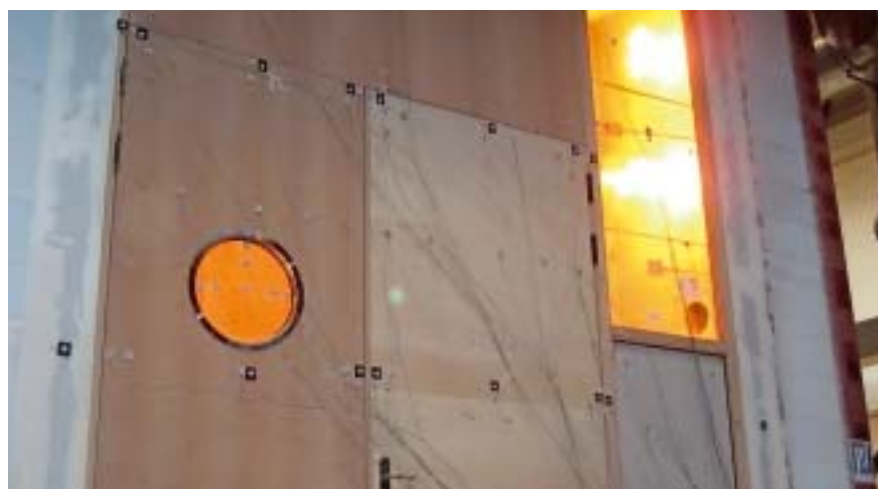
Brandprüfung der Brandschtür Typ 70–2 im März 2013.
